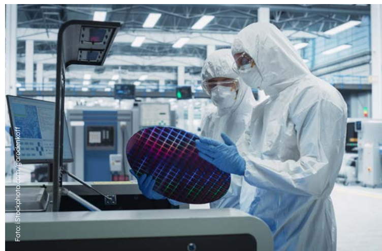
Fertigung von Halbleitern unter Reinraumbedingungen
